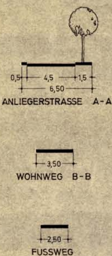
STRASSENRECL. QUERSCHNITTE M. 1:200
